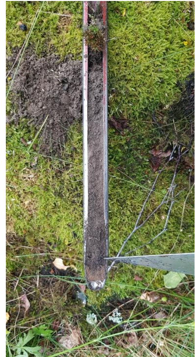
Kuva 31. Koepistosta havaittiin noensekainen tumma kerros noin 20 cm syvyydestä.
